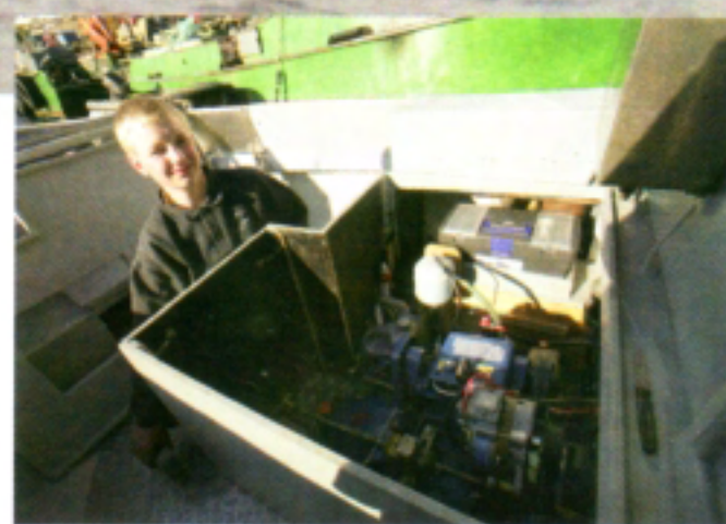
GAMMEL OG SOLID: Yanmar-motoren om bord i Hilmar 2 er ensylindret med en effekt på 8 hk.
