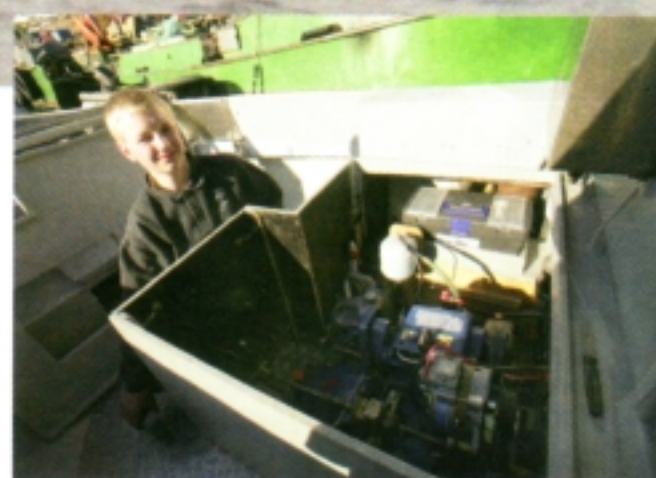
GAMMEL OG SOLID: Yanmar-motoren om bord i Hilmar 2 er ensylindret med en effekt på 8 hk.
