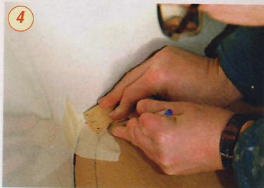
4 KLARING: Ved hjelp av en liten kloss eller lignende med riktig mål, markeres klaringen mellom skrogsiden og dollbordet. Dermed sikrer man at markeringen av avstanden blir jevn hele veien.
