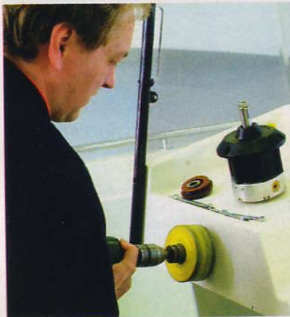
BILDE 2. INN FESTING AV STYREPUMPE
