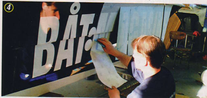
4 TA TAK i bakpapiet og fjern dette forsiktig og gradvis. Ved hjelp av hendene, eller en applikasjonsskrape, presses dekoren til underlaget. Fjern bakpapiet gradvis mens du arbeider deg nedover. Vær forsiktig og omhyggelig slik at alle luftbobler forsvinner.
