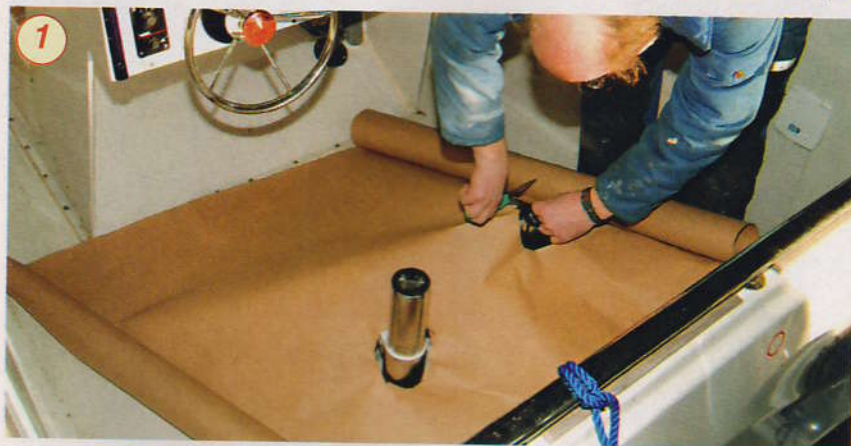
1 TILPASS papiret i forhold til ulike utsparinger, stolstøtter, sluk m.v.
