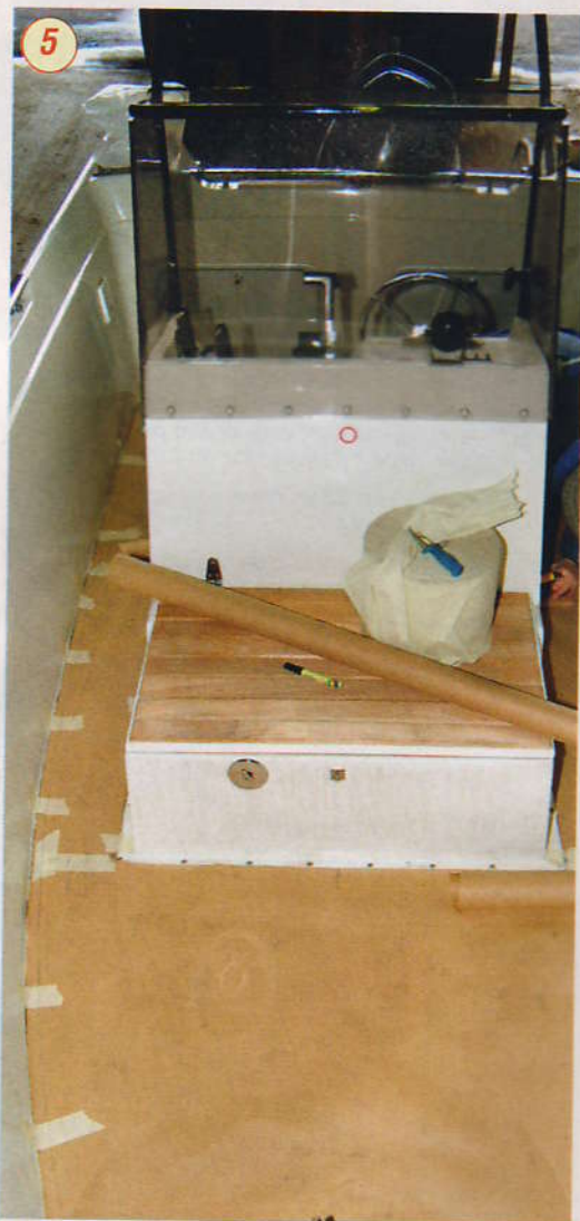
5 AVSLUTNING: Man må selv vurdere hvor de enkelte panelene skal avsluttes. På vår båt var det naturlig å avslutte på hver side av konsollen.
