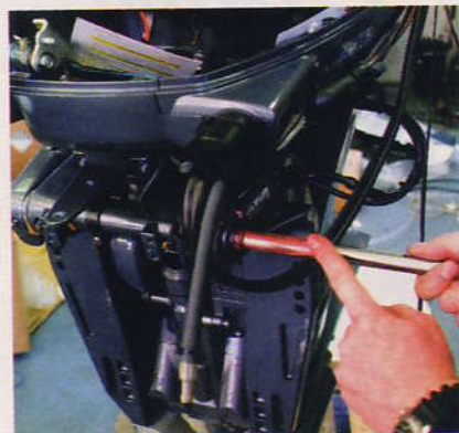
BILDE 4. FESTEAKSEL I RIGGERØR
