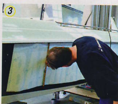
3 JUSTÉR folien slik at bokstavene bli festet i lik høyde bortover skrogsiden eller det underlaget dekoren skal klebes på. Splitte deretter folien mellom hvert tegn med en saks.
